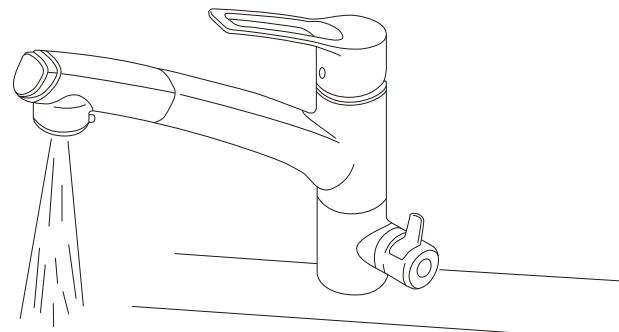
実行 新しいフィルターカートリッジに交換した最初の通水時に濁った水が出てきますが、活性炭と水が混ざったもので、身体に害はありません。最初に、20分間以上通水させてから、ご使用ください。
