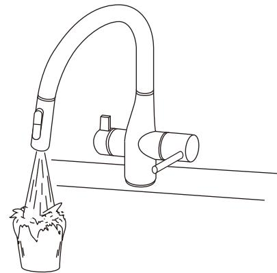
実行 新しいフィルターカートリッジに交換した最初の通水時に濁った水が出てきますが、活性炭と水が混ざったもので、身体に害はありません。最初に、20分間以上通水させてから、ご使用ください。
