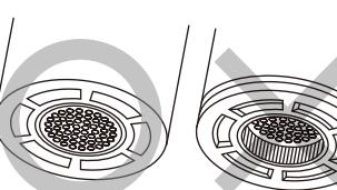
【お願い】止まるまで締め込んだら、それ以上締め込まないでください。破損するおそれがあります。締め付け不足の場合、漏水や切換不良の原因になります。
