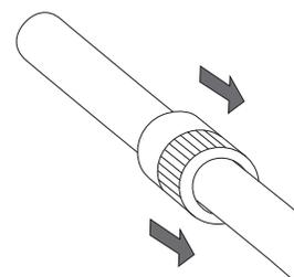
給水ホースが長すぎる場合は、適当な長さに切断してから取り付けてください。(給水ホースは直角に切断してください。)
