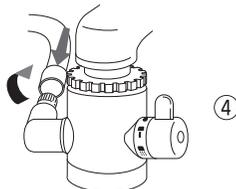
給水ホースを差し込んで締め付けます。(次ページの「4.切替コックと給水ホースの接続」を参照してください。)
