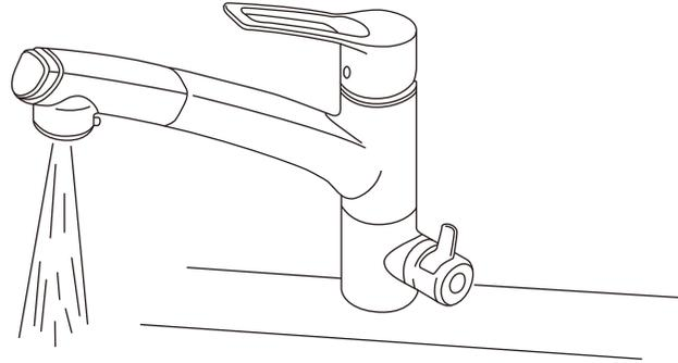
**！ 実行** 新しいフィルターカートリッジに交換した最初の通水時に濁った水が出てきますが、活性炭と水が混ざったもので、身体に害はありません。最初に、20分以上通水させてから、ご使用ください。
